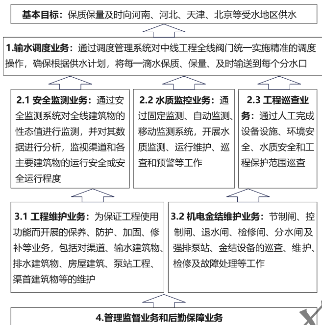
图1 中线工程运行维护管理的业务结构
