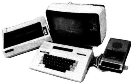
该系统由H-01中文电脑、打印机、显示器和磁带机构成。采用该系统后可大大减轻票据交换工作量，提高工作效率。帐目出错时，机器会自动给出显示，提供修改机会。由于配置有H-01中文电脑，还可用BASIC编程实现各种报表及中文文件的打印，是办公室自动化的有力工具。
