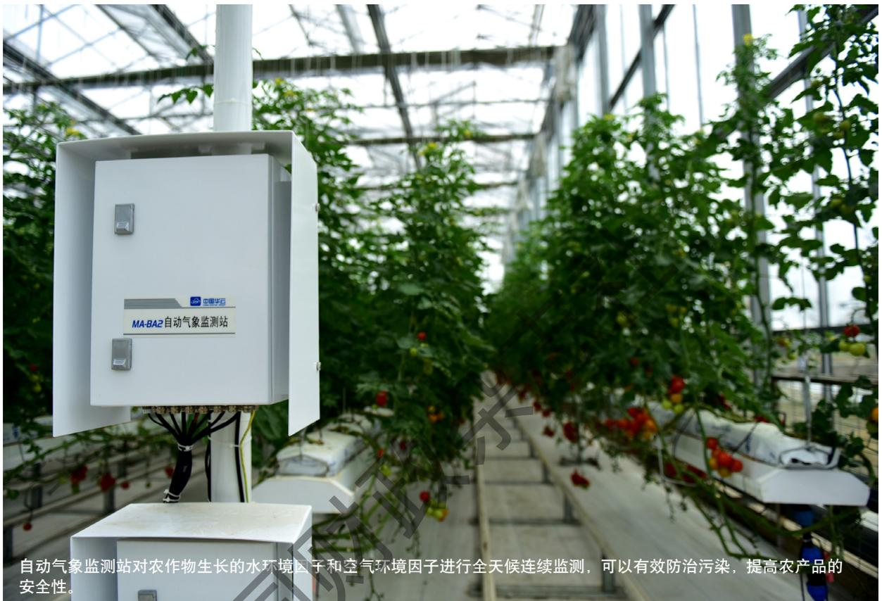
自动气象监测站对农作物生长的水环境因子和空气环境因子进行全天候连续监测，可以有效防治污染，提高农产品的安全性。
